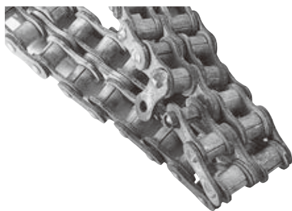
ステンレスドライブチェーンの腐食
