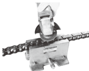
図6.アタッチメント付チェーン 図7.ピンの端部を削る
